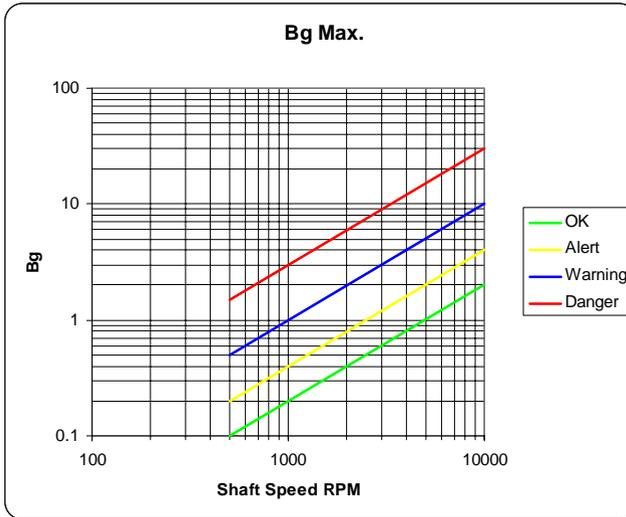
La mesure Bg ou Bv indique la vibration mesurée dans une bande de fréquence [1000 Hz – 12000 Hz].
